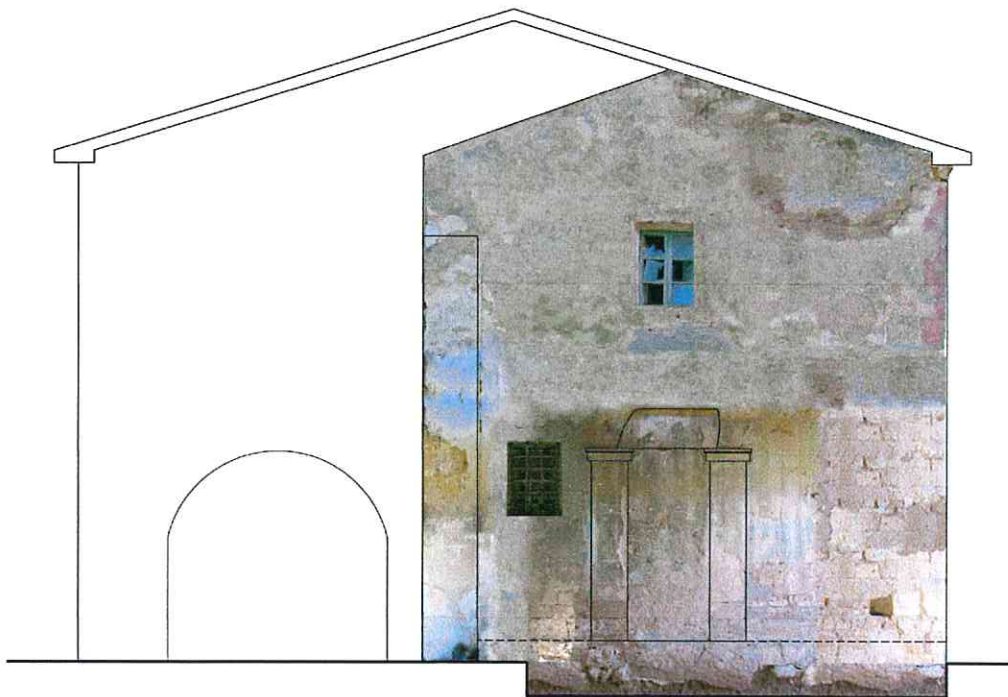
Foto 12: Lato Ovest – Raddrizzamento fotografico facciata vecchia Chiesa
