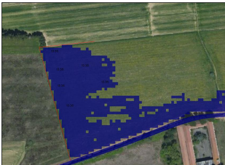
Figura 83 Quote liquide nell'area di contenimento delle acque provenienti da rottura arginale
