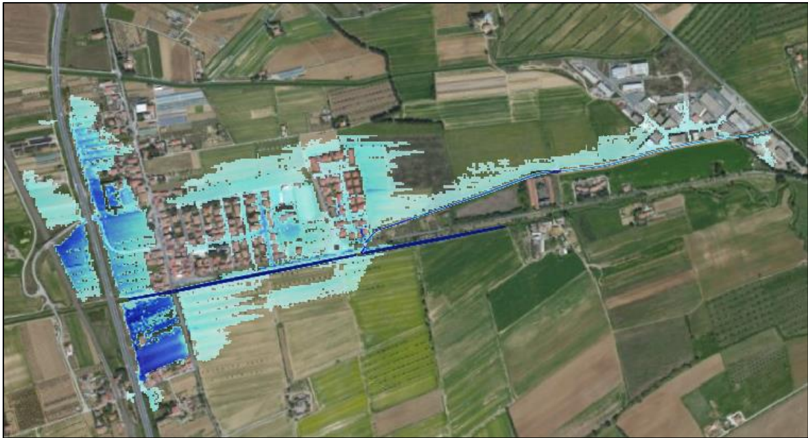
Figura 46 Esondazioni nell'ipotesi di rottura arginale per T_r=200 anni a t=3h
