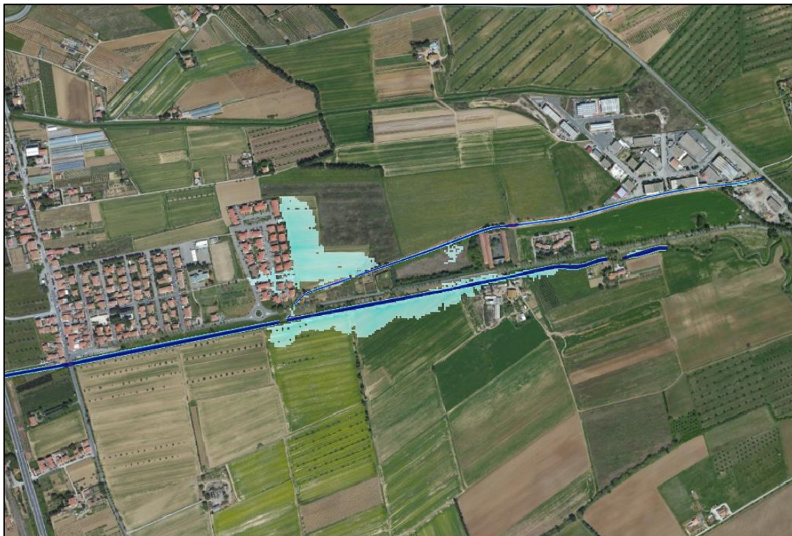
Figura 40 Esondazioni a t=2:15 h per Tr=200 anni nell'ipotesi per analisi con sottrazione di portata a monte della confluenza sul F. della Madonna
