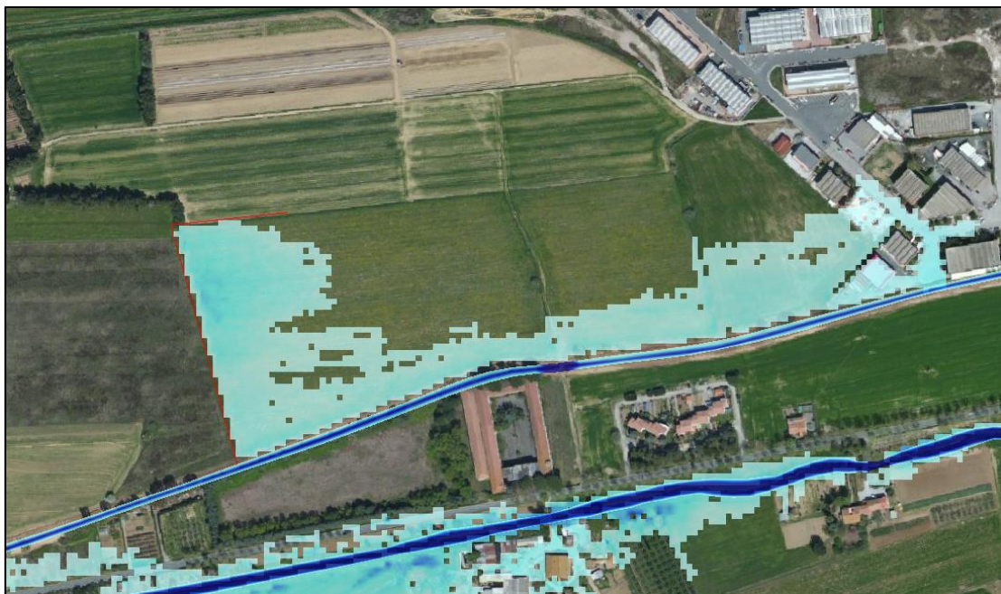
Figura 82 Contenimento delle acque provenienti da rottura arginale
